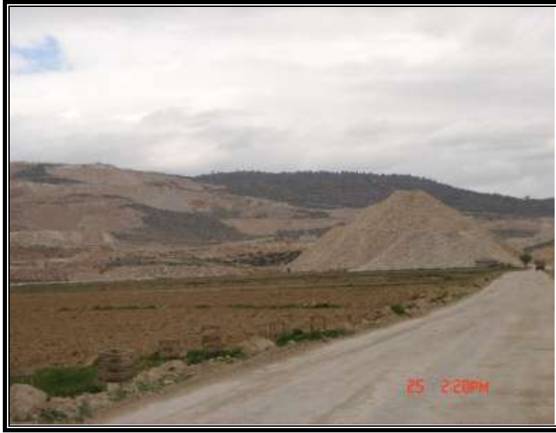
Foto 2. Mermer-Traverten Ocaklarından Çıkan ve Tarım Alanları İçin Fiziksel Kirlilik Tehlikesi Oluşturan Kırıntı Yığınları Photo 2. Subtrahend from stoves of the Marbles and Traverten And the sweep chunks having been dirtiness jeopardy.
