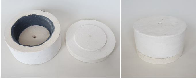
Görsel 1. Mikrodalga Fırın içerisine konan Mikrodalga Füzyon Fırın (Fuseworks Microwave Kiln) fırını (Kişisel Arşiv).
