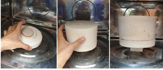
Görsel 3. Fırının Mikrodalga Fırına yerleştirilmesi (Kişisel Arşiv).
