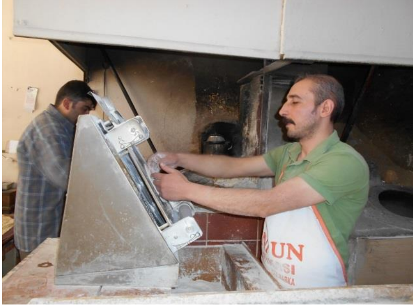
Resim 4: Küntlerin hamur açma makinesiyle yufka haline getirilmesi
