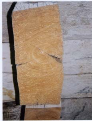
Resim:23 Dendrokronoloji yntemi ile 1204, 1205 ve 1211 yıllarının belirlendiĐi diĐer aĐa kesiti.
