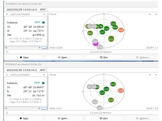
Şekil 4. Kinematik deneyler sırasında gerçekleştirilen çözümlerden bir görünüm (Üst: RT-PPP GE, Alt: RT-PPP G)
