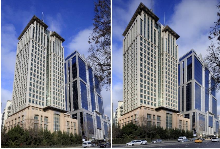
Fotoğraf 12: Solda Canon TS objektife herhangi bir hareket uygulamadan yapının altından yapılan çekimle, sağda TS objektifle yapıya paralel bakarken dikeyde shift hareketi en üstteyken yapılan çekimin farklı perspektif etkileri (Fotoğraflar: Özer KANBUROĞLU)
