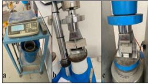
Şekil 5. Sertleşmiş harç numunelerine uygulanan deneyler; a) Görünür porozite ölçümleri b) Eğilme dayanımı c) Basınç dayanımı
