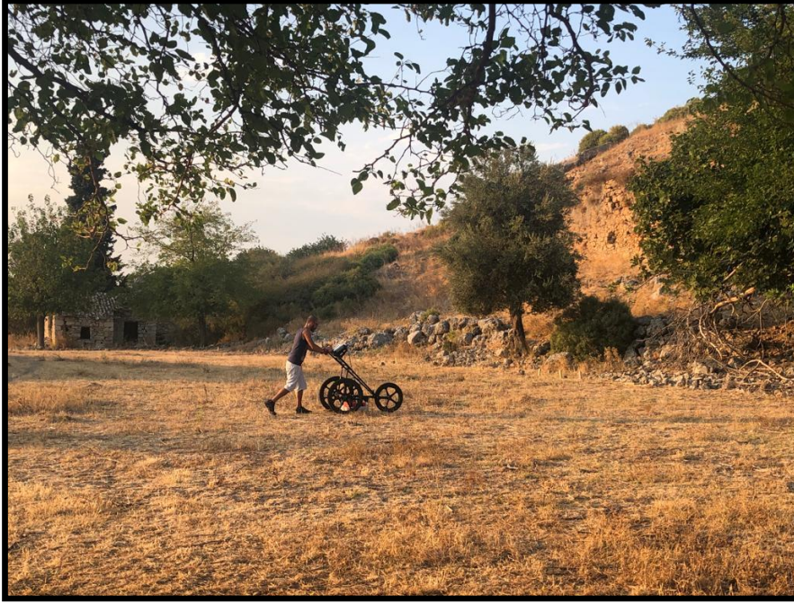
Şekil 4. GSSI SIR-3000 yer radarı cihazı ile stadyum bölgesinde ölçü alımı Figure 4. Measurement in the stadium area with GSSI SIR-3000 ground penetration radar
