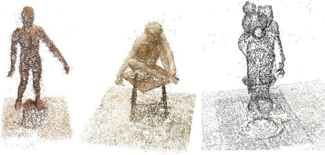
Şekil 5. ön dengeleme sonrasında oluşan seyrek nokta bulutu (sol: obje 1 – orta: obje 2 – sağ: obje 3)
