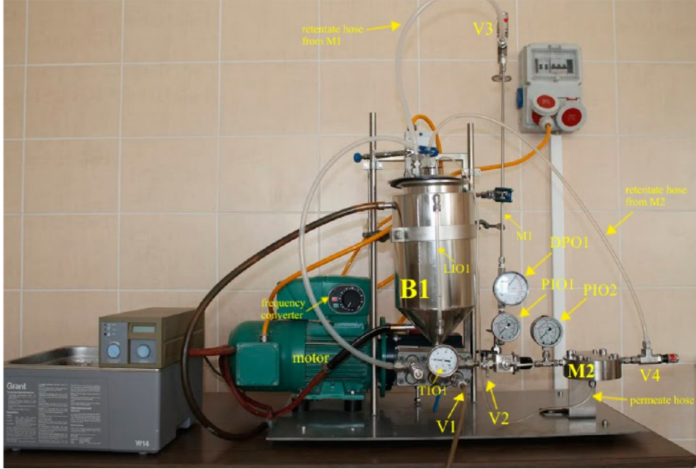
Şekil 1. Membran arsa tesisinin akış diyagramı. (M2: membran muhafaza; B1: sıcaklık kontrollü besleme tankı; PI01 ve PI02: manometre; DP01: basınç göstergesi; LI01: besleme tankındaki seviye kontrol göstergesi; TI01: sıcaklık göstergesi, V1 ve V2: tahliye valfi; V3: basınç düzenleme valfi; V4: yaylı valfi)
