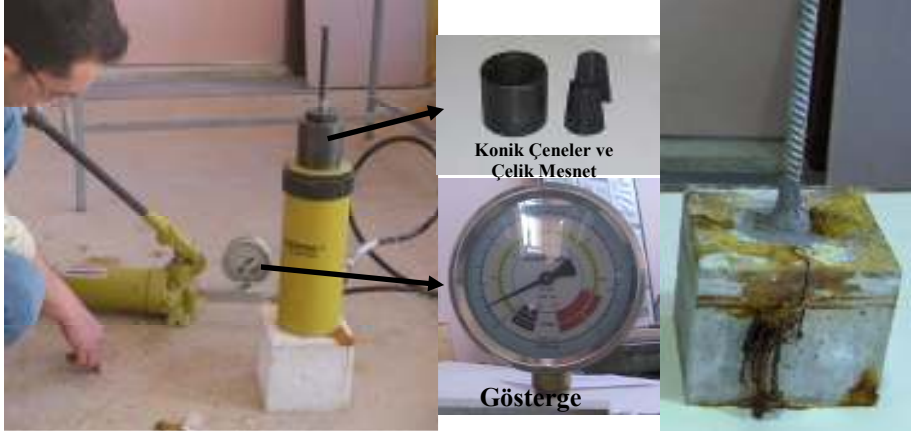
Şekil 2. Aderans deneyi cihazı ve çatlayana kadar korozyona uğratılan numune.
