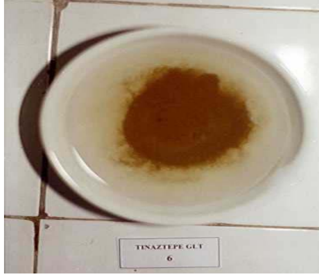
Şekil 2. Tınaztepe Göletine Ait Örnekte Dağılma Deneyi
