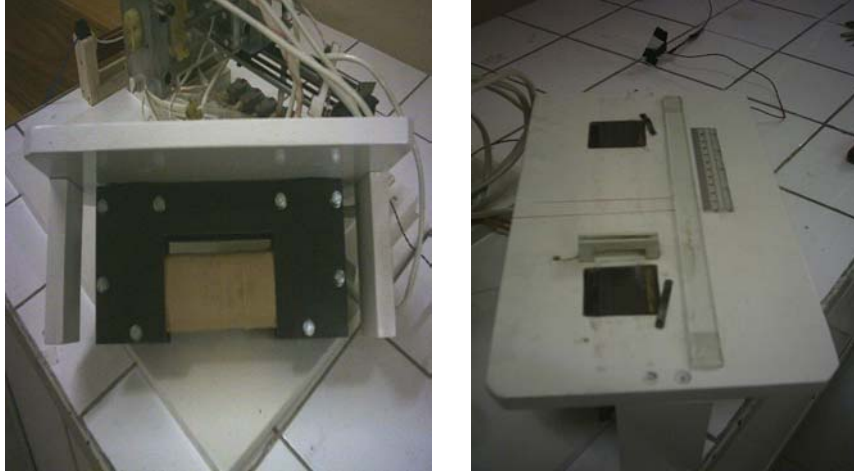
Şekil 3. Manyetize edici U çekirdeğin görünümü.
