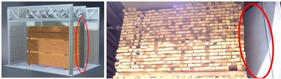
Şekil 2. İstif kenarları için dikey kanatçık örnekleri (Katres, 2022; SPIB, 2023)
