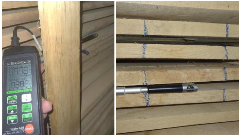
Şekil 9. Ölçüm penceresinde hava hareket hızı ölçümü
