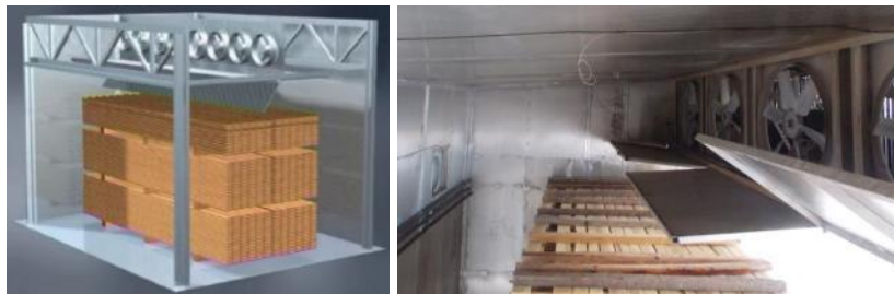
Şekil 3. İstif üstü için yatay kanatçık örnekleri (Katres, 2022)
