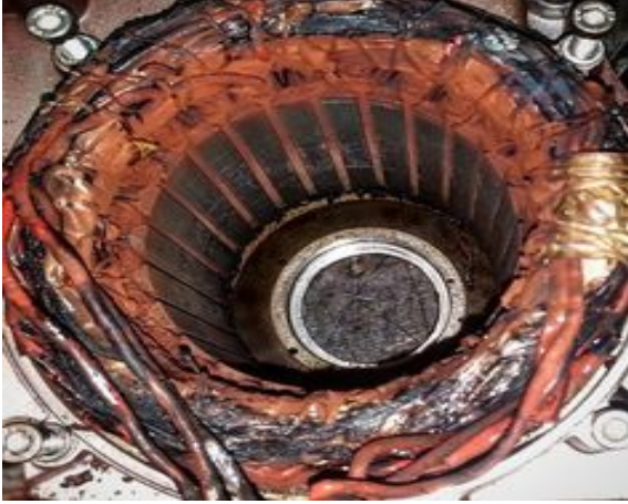
Şekil 3. Tipik bir asenkron motor stator sargı arızası.
