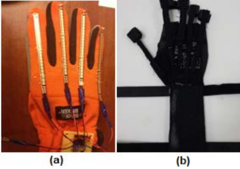
Şekil 7. Kablosuz eldiven sistemleri: (a) ilk eldiven prototipi, (b) ikinci eldiven prototipi.
