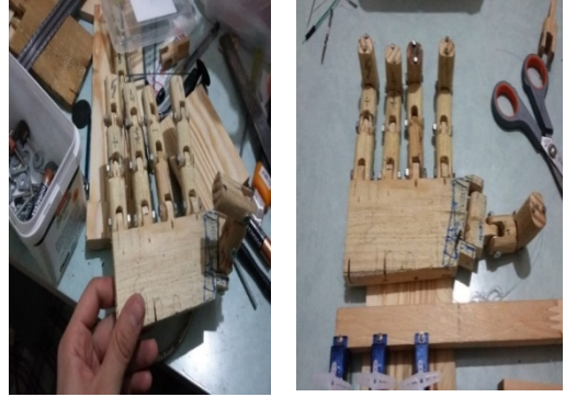
Şekil 1. Ahşap malzeme kullanılarak gerçekleştirilen ilk prototip
