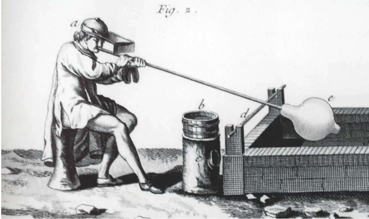
Resim 5. Üfleme tekniği, kullanıldığı ilk yıllarda yüksek koruma gerektiren zorlu ve tehlikeli bir şekillendirme yöntemidir. Günümüz teknolojisi bu tehlikeleri azaltmışsa da ilk zamanlarda ateşin kor ve sıcaklığından gözlerin korunması için koruyucu bir siperliğe ihtiyaç duyulmaktadır. Cam ustası uzun bir demir çubukla ateşten olabildiğince uzakta, nefesle camı şekillendirmeye çalışmaktadır. Kor havuzunun hemen yanında ağaç kütüğünün üzerinde bir kova su bulundurulur ve bu su birkaç amaçla kullanılırdı. Örneğin; ısınan demir çubuğun, ıslatılmış bezle sıcaklığının düşürülmesinde veya şekillendirilmiş camın soğutulmasında kullanılabilir. Böylece daldırma yöntemiyle soğutulan cam ürünün çatlaması da engellenmiş olurdu. (Kaynak; Hess, 2005, s. 7)
