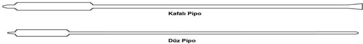
Resim 4. Sıcak cam hamurunu şekillendirmek için kullanılan piponun, temelde iki çeřidi vardır. Kafalı ve düz pipo. Ancak uçları deđiřtirilerek yeni ađızlı pipolar da kullanılmaktadır.
