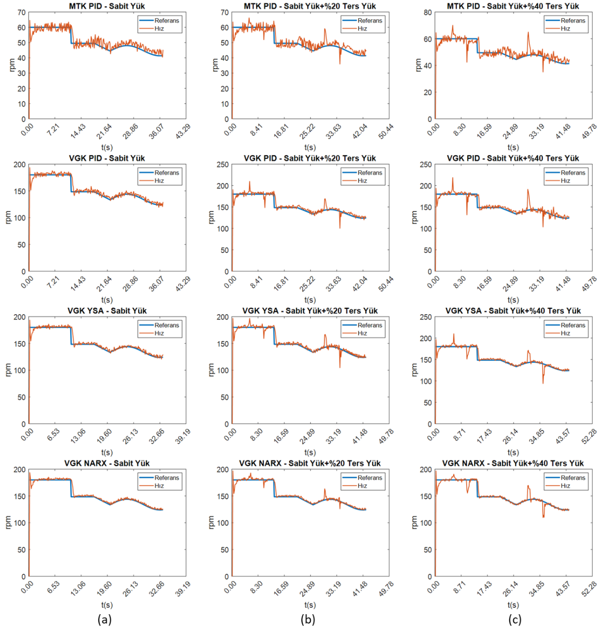
Şekil 9. DAM2 için sırasıyla MTK-PID, VGK PID, VGK-YSA ve VGK-NARX denetleyicilerinin (a) sabit yük, (b) sabit yük + %20 ters yük değişimi, (c) sabit yük + %40 ters yük değişimi tepkileri ((a) Constant load, (b) constant load + 20% reverse load change, (c) constant load + 40% reverse load change responses of MTK-PID, VGK PID, VGK-YSA and VGK-NARX controllers for DAM1, respectively)
