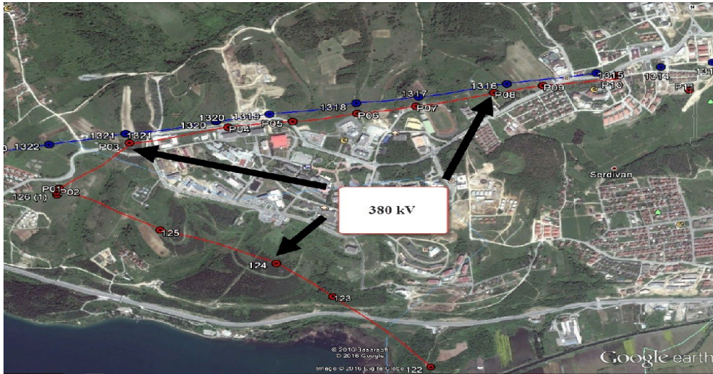
Şekil 1. 380 kV Temelli Fideri hattının uydu fotoğrafı görüntüsü (Satellite photo view of 380 kV Temelli Fideri line)
