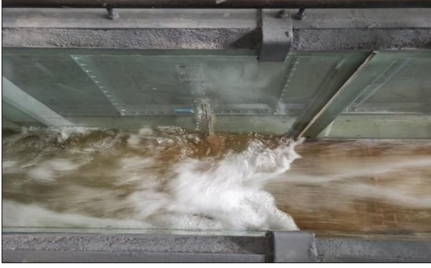
Şekil 9. Tipik bir hidrolik sıçrama olayı esnasında gözlenen türbülans.
