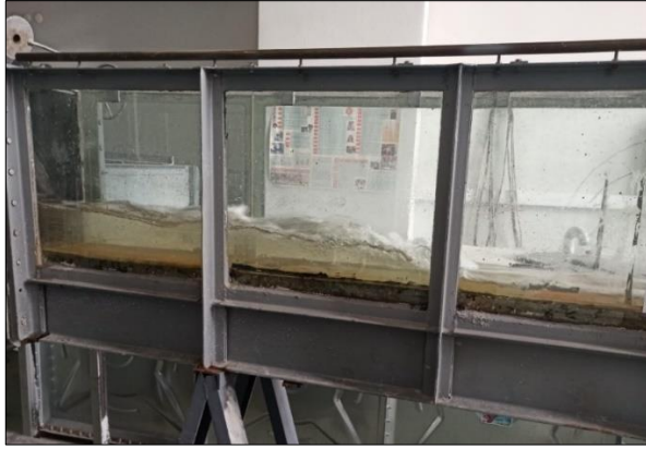
Şekil 19. Durum 1 için gözlenen hidrolik sıçrama sonrası su yüzeyi profili görüntüsü.
