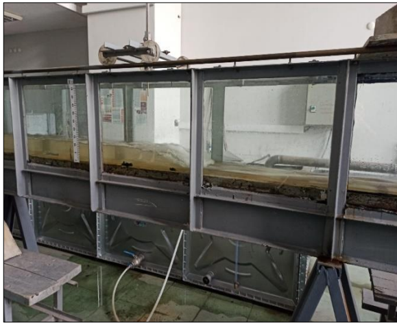
Şekil 20. Durum 2 için gözlenen hidrolik sıçrama sonrası su yüzeyi profili görüntüsü
