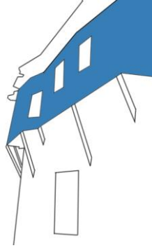
Şekil 13: Cumalıkızık bina kabuğu biçimlenişi: Cumba (Öztürk, B., 2023)
