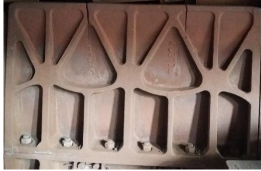
Şekil 1. Palet üzerinde çalışmış ve hasara uğramış palet yan duvarı
