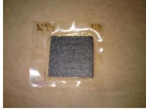
**Figure 5.** Membrane Electrode Assembly (Membran Elektrot Düzeneği)
