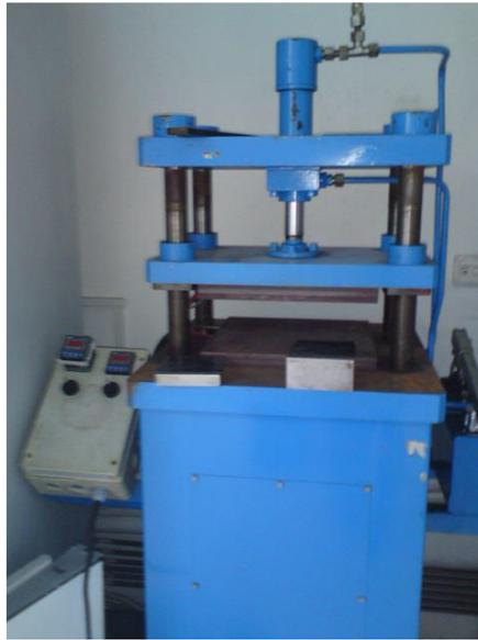
**Figure 6.** Hot Press Device (Sıcak Pres Cihazı)
