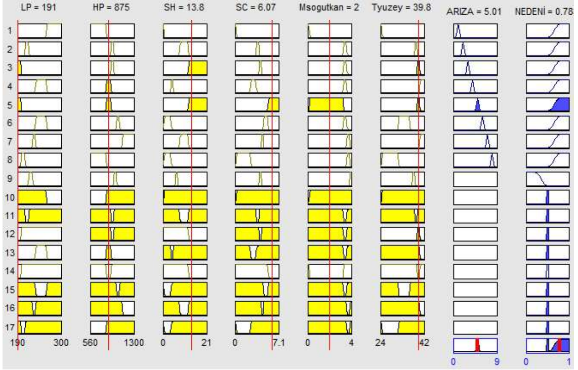
Şekil 5. Yetersiz soğutkan için arıza kodu 5'e ait kural görüntüleyici çıktısının görünümü.
