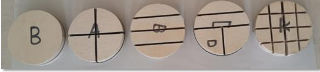
Şekil 2. Akustik özelliklerin tespit edilmesinde kullanılan test örnekleri (Sağdan Sola Doğru Sırasıyla; Baklava Dilimi Yüzey Formuna Sahip Panel, Asimetrik Yüzey Formuna Sahip Panel, Şeritli Yüzey Formuna Sahip Panel, Pizza Dilimi Yüzey Formuna Sahip Panel ve Daire Yüzey Formuna (Düz Yüzey) Sahip Panel)
