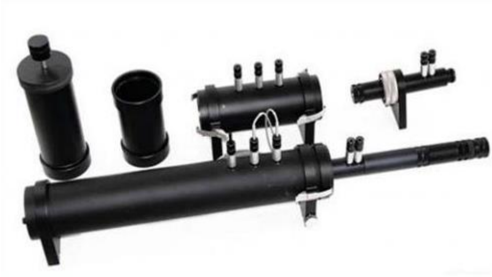
Şekil 4. Üretilen panellerin akustik özelliklerinin belirlenmesinde kullanılan empedans tüpü ölçüm sistemi (URL-1)
