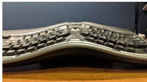
Şekil 3. Yanal eğim/çadır açısı Kaynak: https://en.wikipedia.org/wiki/Ergonomic_keyboard
