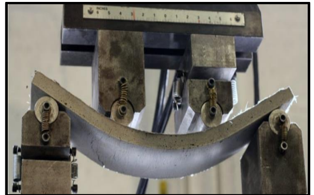
Şekil 11. Bükülebilir betonda eğilme deneyi (Malzeme Bilimi, 2023)
