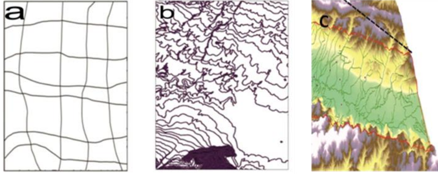
Şekil 2: Sayısal yükseklik modellerinin yapısı (a) Eşyüksekti eğrileri, (b) sabit aralıklarla elde edilmiş eş yüksekti eğrileri, (c) DEM.
