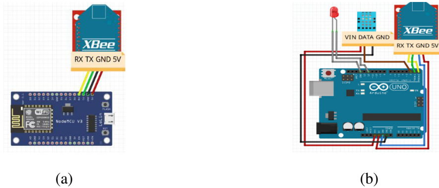
Şekil 2.a Alıcı devre şeması, b. Verici devre şeması
