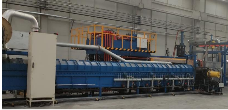
Şekil 1. Ön ısıtma işlemi için kullanılan biyet fırını
