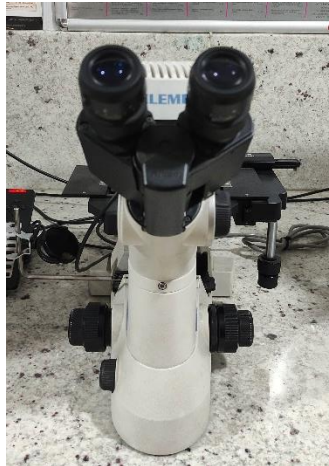
Şekil 5. Mikroyapı kontrollerinin yapıldığı optik mikroskop
