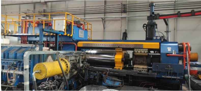
Şekil 2. Deney profilinin elde edilmesinde kullanılan ekstrüzyon pres
