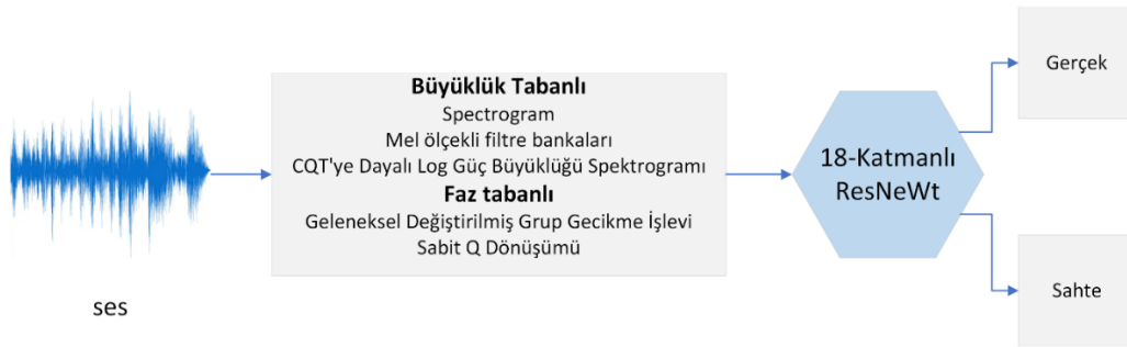
Şekil 17. Büyüklük ve Faz tabanlı özellikler ile 18 katmanlı ResNeWt mimarisi ile derin sahte ses tespiti (Cheng ve ark., 2019).
