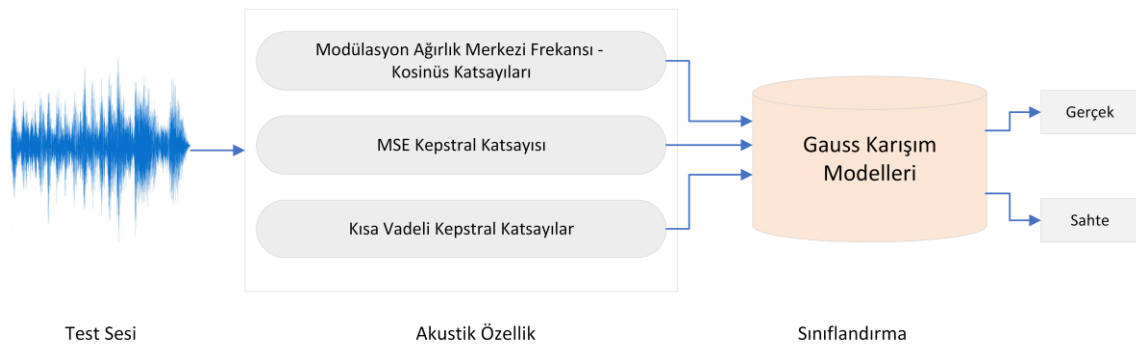
Şekil 15. Üç farklı akustik özelliklerin Gauss Karışım Modellemesi ile sınıflandırılmasına dayalı derin sahte ses tespiti yöntemi (Suthokumar ve ark., 2018).
