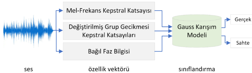
Şekil 5. Üç farklı akustik özelliğin Gauss Karışım Modeli ile sınıflandırılmasına dayalı derin sahte ses tespiti yöntemi ( Wang ve ark., 2015 ).
