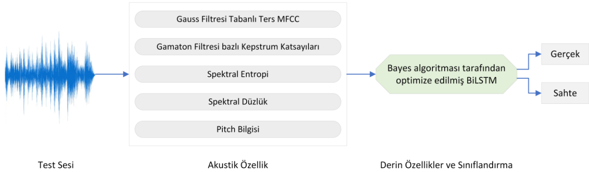
Şekil 40. Mewada ve ark. (2023) tarafından derin sahte ses tespiti için önerilen beş farklı akustik özellik ve Bayes tarafından optimize edilmiş BiLSTM'nin kullanıldığı mimari.
