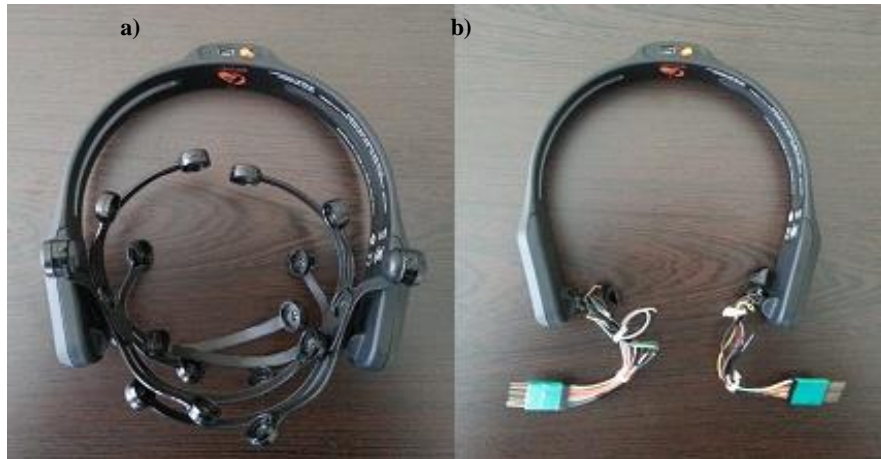
Şekil 3 a) Orijinal Epc cihazı (Original Epc EEG device) b) Mikro kontrolcü için erkek soket kullanılarak uyarlanmış Epc cihazı (Modified Epc device with male sockets from microcontroller)
