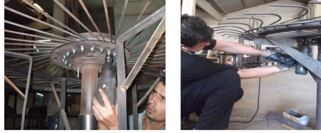
Şekil 4. Yıldız çarkının montaj işlemi (The assembly process of wheel rake)
