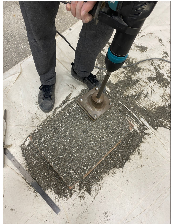
Şekil 8. Titreşim cihazı yardımıyla GDA – kum karışımı zemine yapılan rölatif sıklık deneyi.
