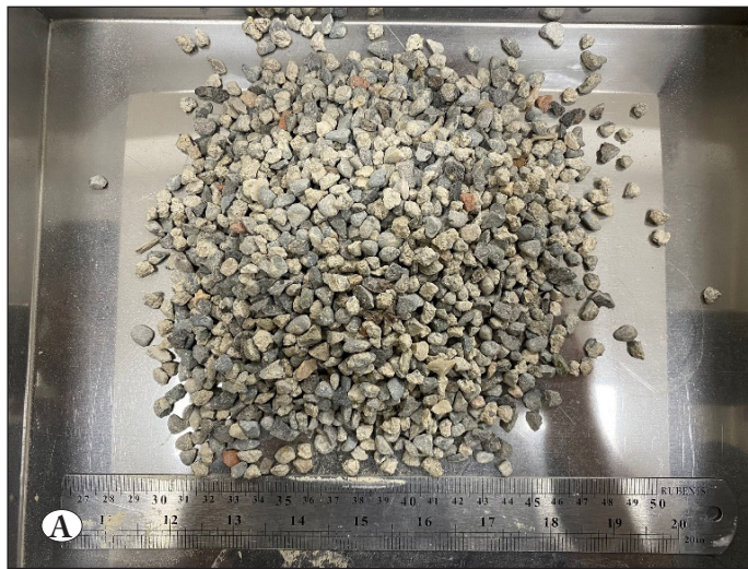
Şekil 4. 4.76 mm-6.30 mm (A) ve 2mm-4.76 mm (B) boyutlarına sahip GDA.
