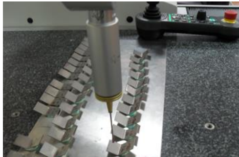
Şekil 3. CMM’de geri esneme ölçümü (The measurement of springback by CMM)
