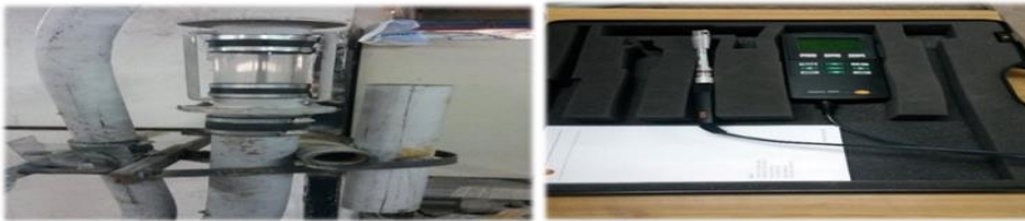
Şekil 2. Kritik hız ölçümünde kullanılan sistem ve dijital anemometre.
