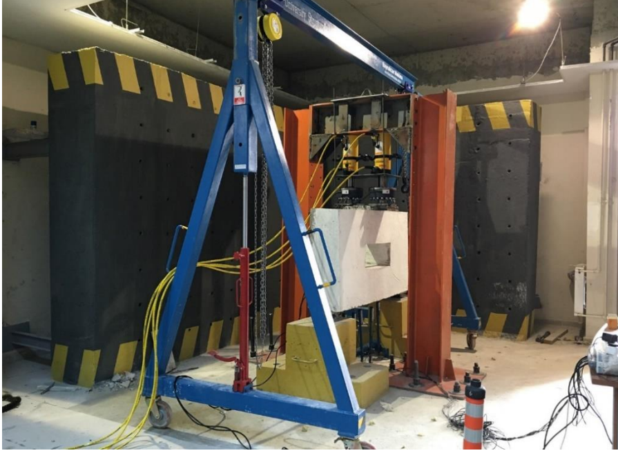
Şekil 4: Rijit yükleme çerçevesi ve deney düzeneği
