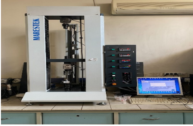
Resim 3: Makaslama bağlanma dayanımı testi için kullanılan universal test cihazı (Marestek, Türkiye).
