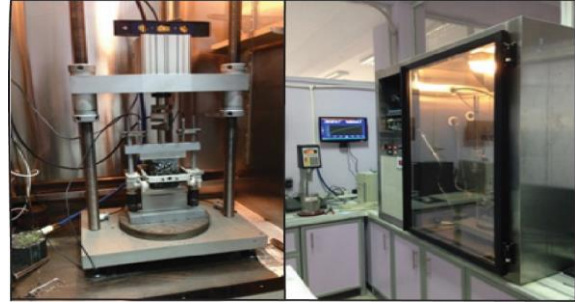
Şekil 2. İndirekt çekme yorulma deney düzeneği
