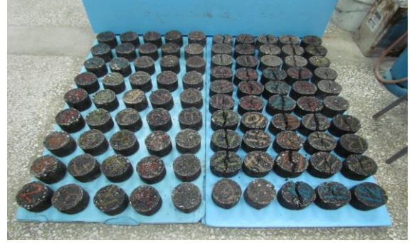
Şekil 4. İndirekt çekme yorulma deneyine tabi tutulan numuneler
