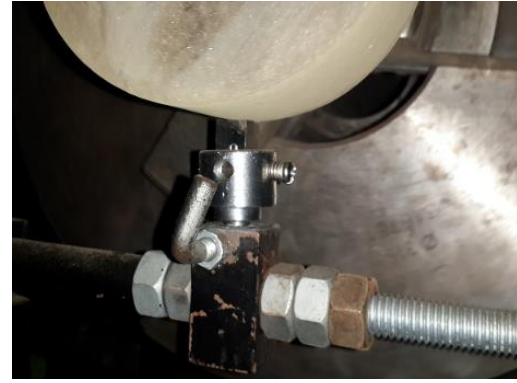
Şekil 5. Abrasive aşınma aparatının şematik görüntüsü ve aşınma temas resmi
