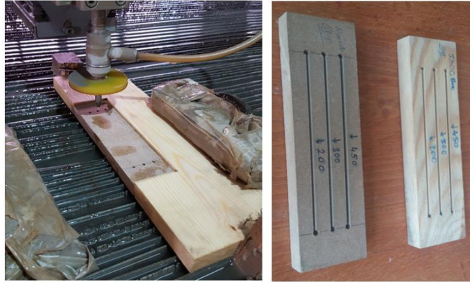
Şekil 2. Örneklerin ASJ sisteminde kesilmesi (Cutting of samples in the AWJ system)
