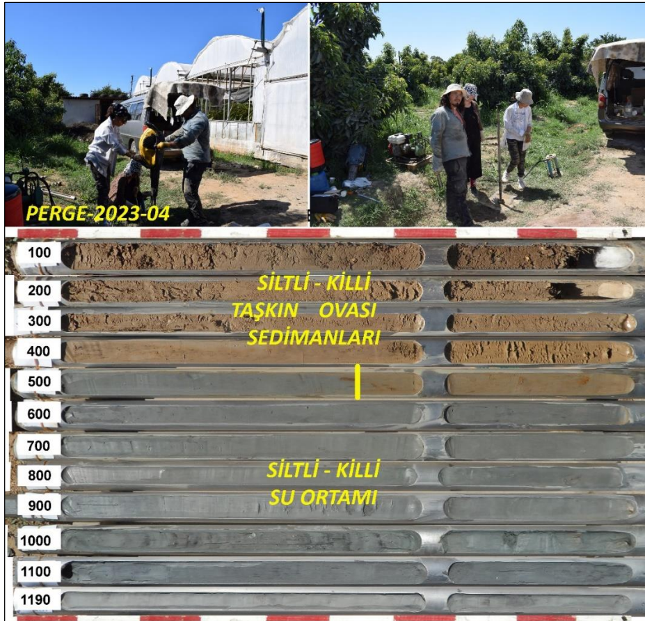
Şekil 8- PERGE-2023-04 (PRG-04) numaralı sondajın birikme ortamı özellikleri.
