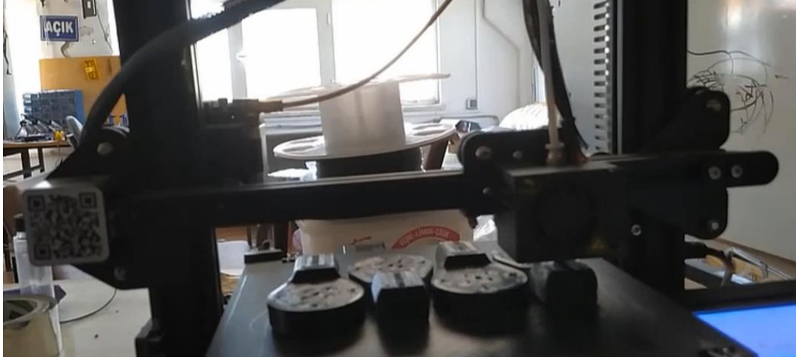
Şekil 1. 3B yazıcı imalat görüntüleri Motor tutucu imalatı
