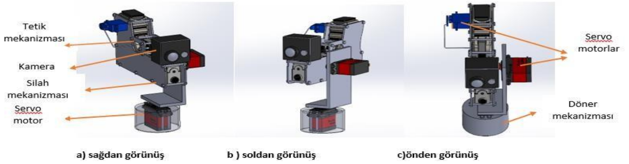
Şekil 14. Silah mekanizmasının tasarım görüntüleri
