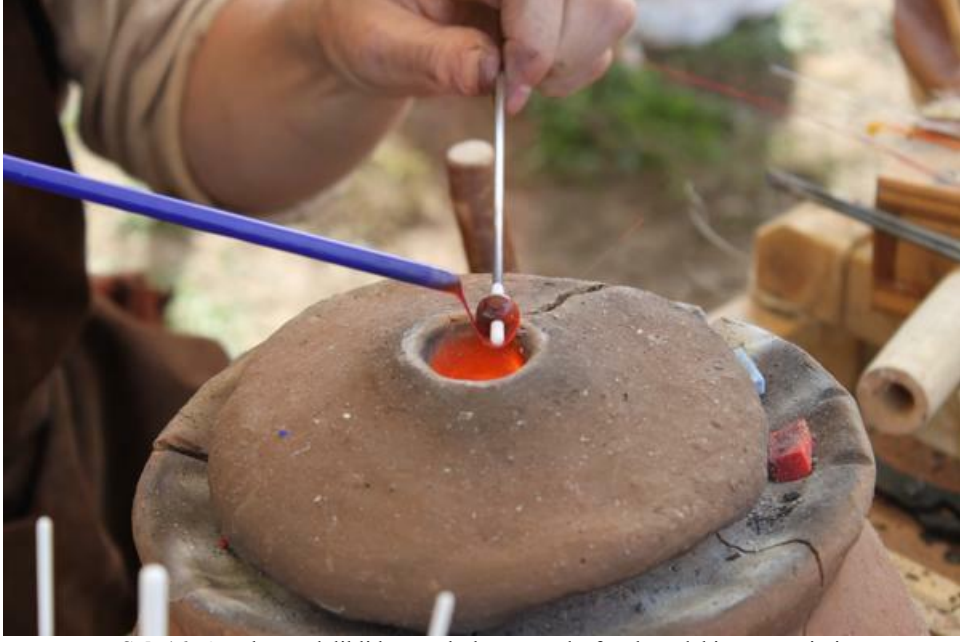
Şek.16: Orta kısmı delikli kapağı bulunan tandır fırınlarındaki cam üretimi.
