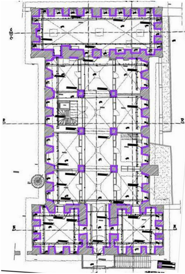
Şekil 12. 2 ve 4 No'lu binalarda tekstil donatılı sıva güçlendirmesinin plan üzerinde gösterimi 25
