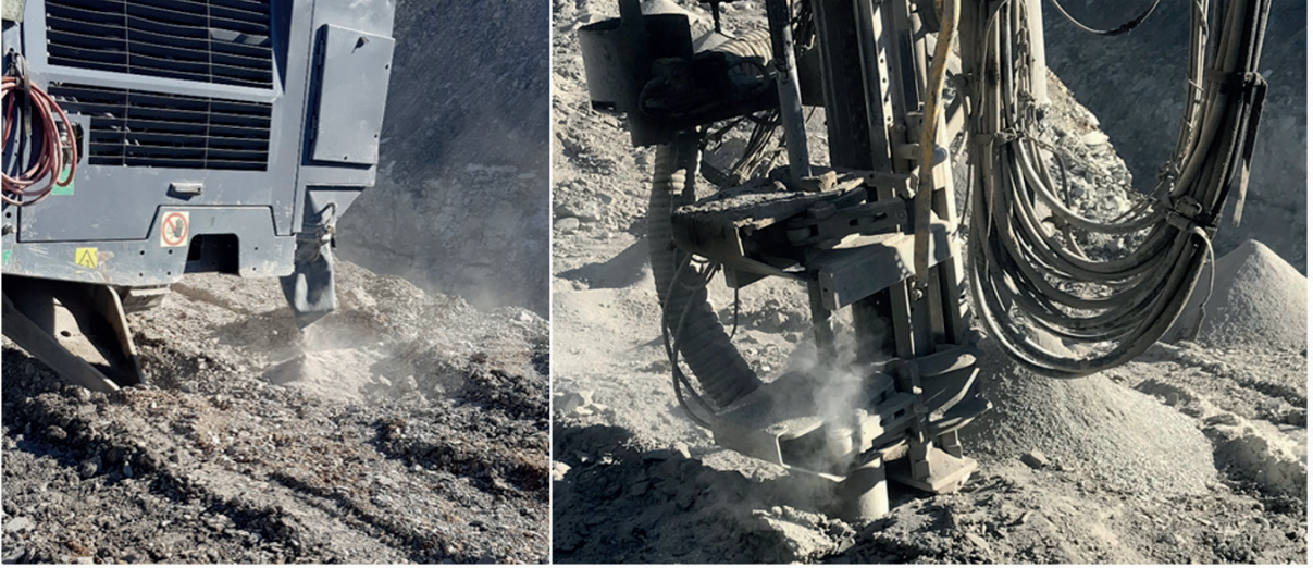
Şekil 3.1. Delik delme işleminde iş makinesinin arkasından ve ön taraftan toz atımı
