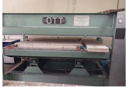
Şekil 2. Çapraz lamine panellerin pres makinesi ile sıkılması
