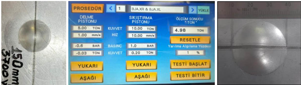
Şekil 13. Erichsen çökertme test görüntüleri ve test sonuçları (Erichsen cupping test images and test results).
