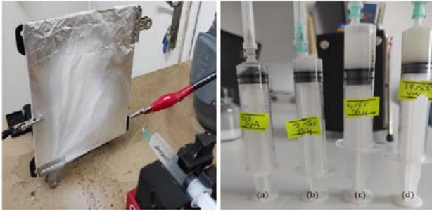
Şekil 2. Elektrospinning işlemi ve PCS katkılı PVA polimer çözeltilerinin görüntüleri
