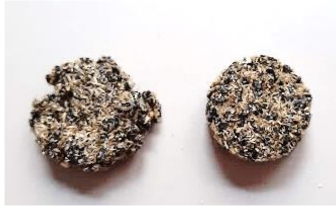
Şekil 5. 250 µm numunelerde 1000 N yük basınç sonrası deformasyon görünümü.
